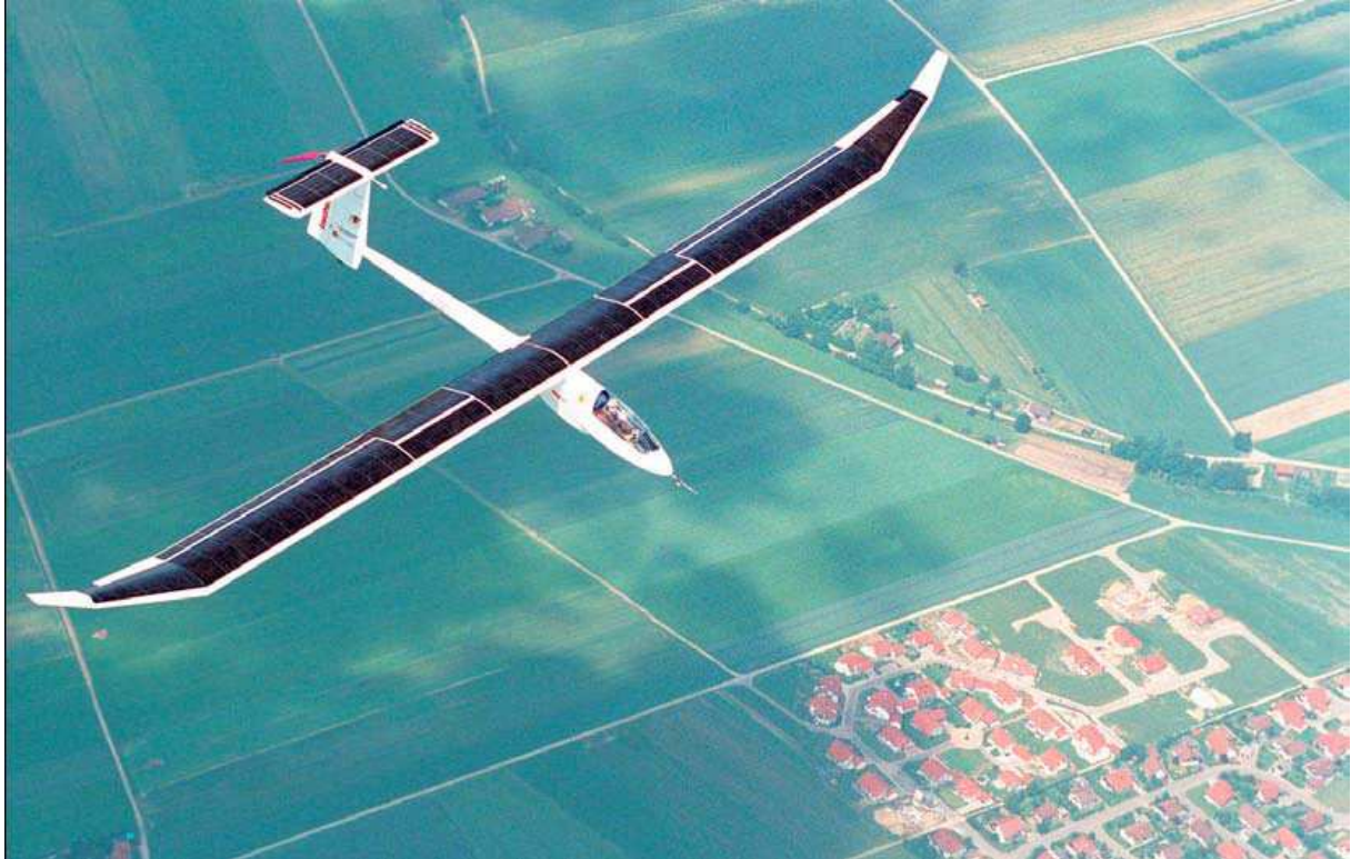
icaré 2, Solarflugzeug des IFB der Universität Stuttgart
